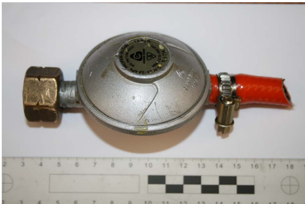
Widok reduktora i odcinka przewodu prawidłowo zabezpieczonego opaską
