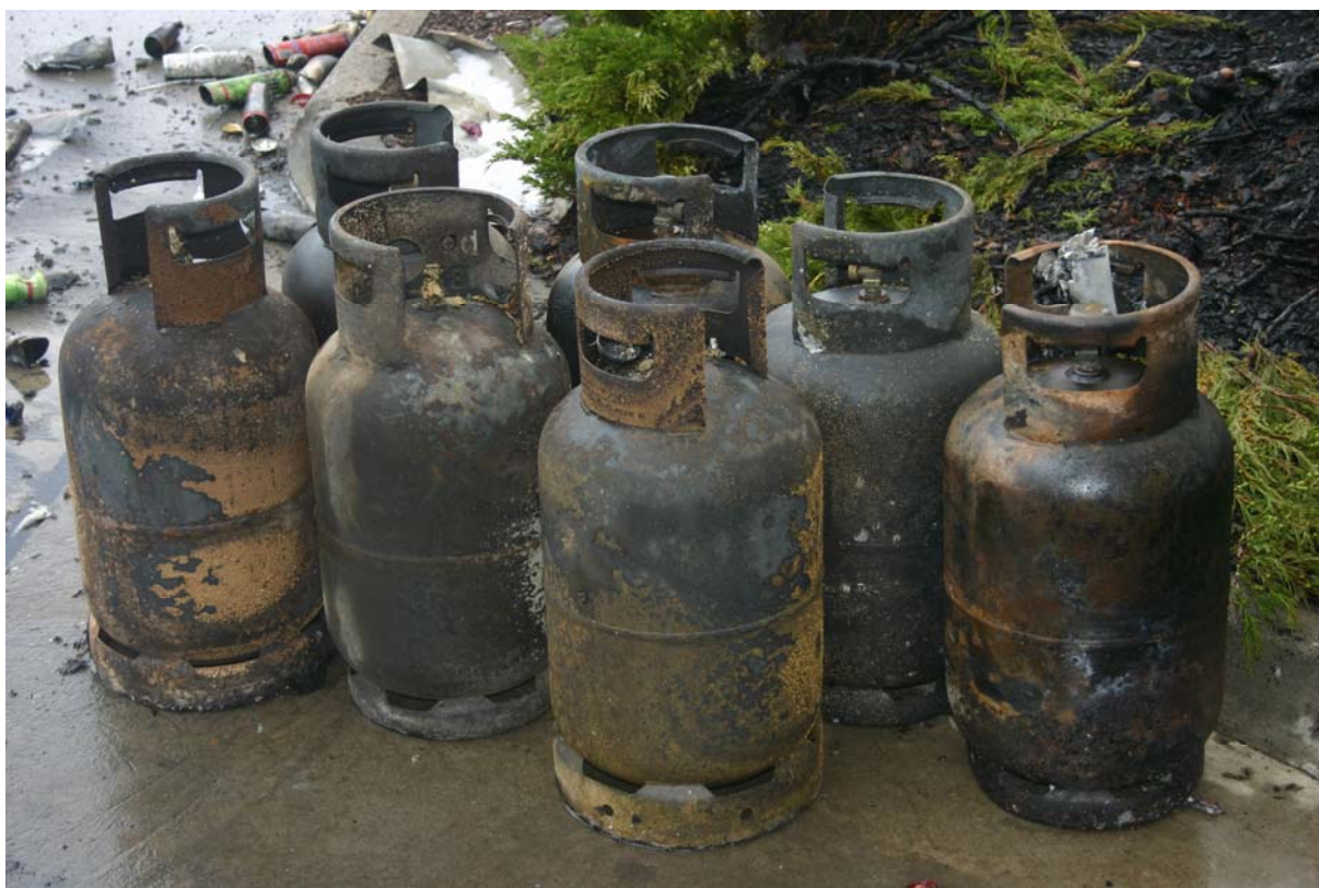
Widok zbiorników propan-butan przeznaczonych do zasilania wózków widłowych 15
