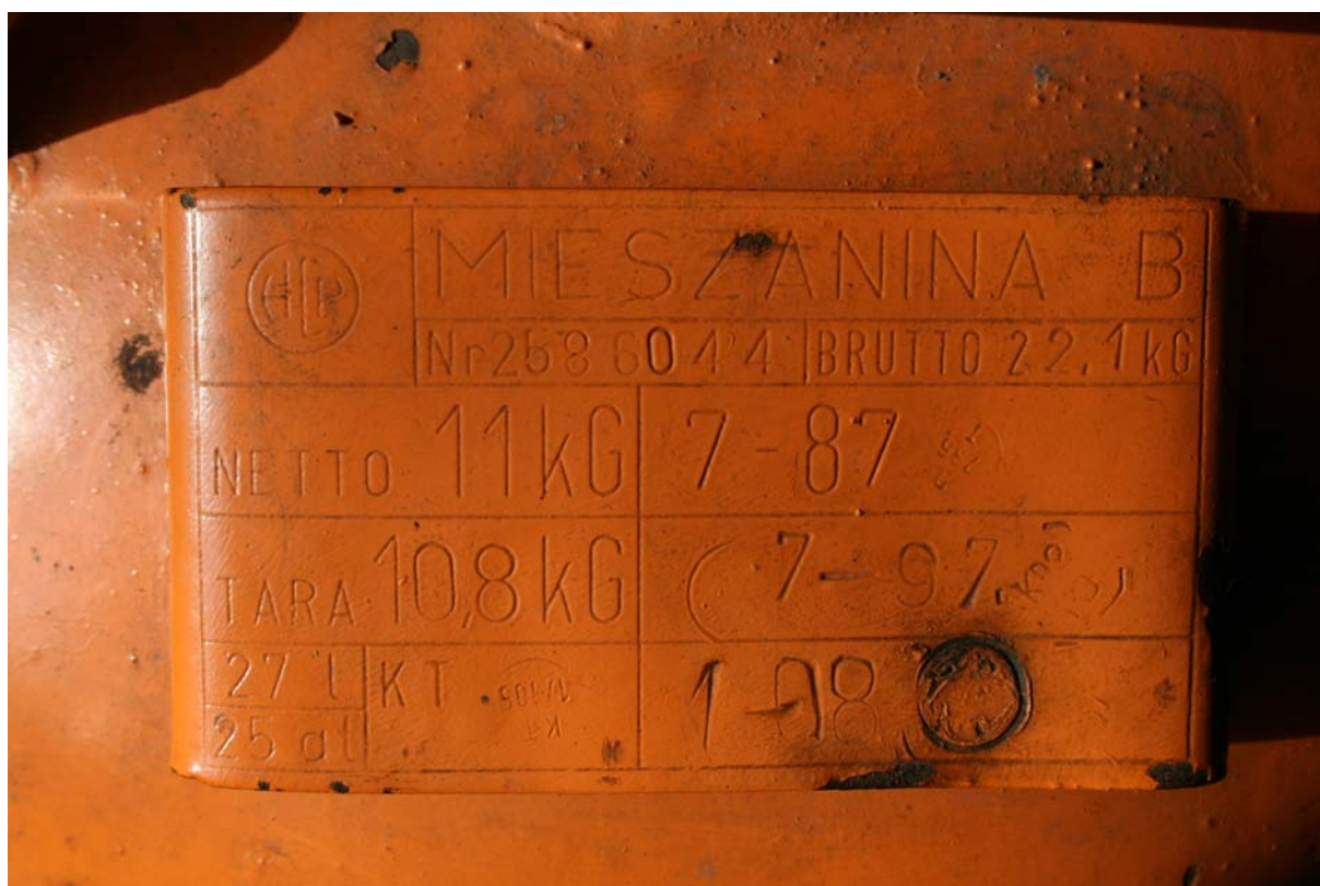
Widok cechy badania technicznego
