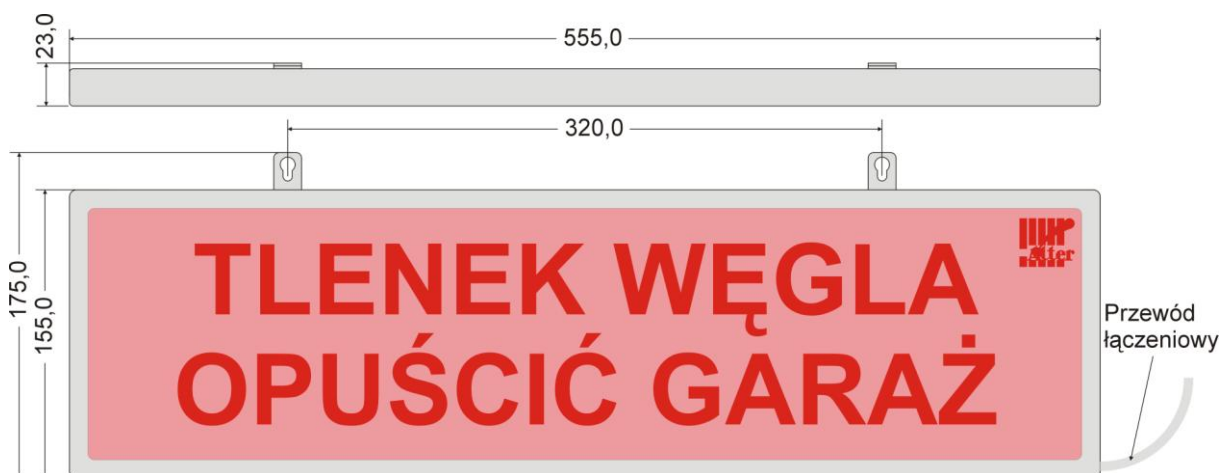
Rys.1. Widok i podstawowe wymiary tablicy OTS-12
