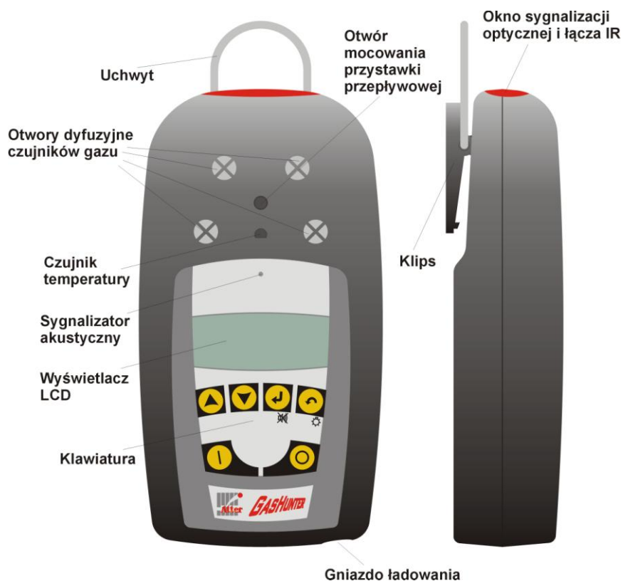
Rys.63. Widok i opis podstawowych elementów miernika GasHunter
