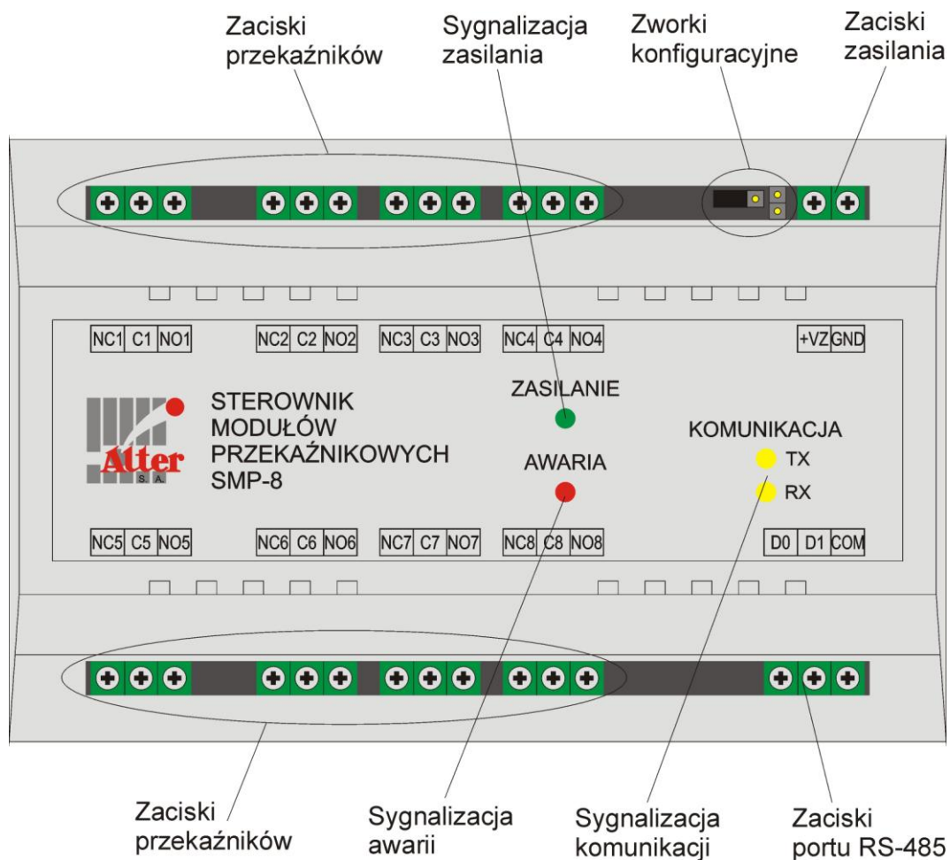
Rys.2. Opis elementów sterownika SMP-8
